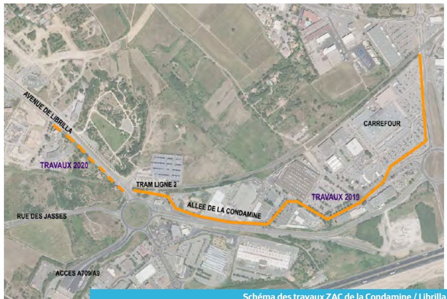
Schéma des travaux ZAC de la Condamine / Librilla Le chantier sera « glissant » (par tranche) pour éviter de paralyser l'activité commerciale
