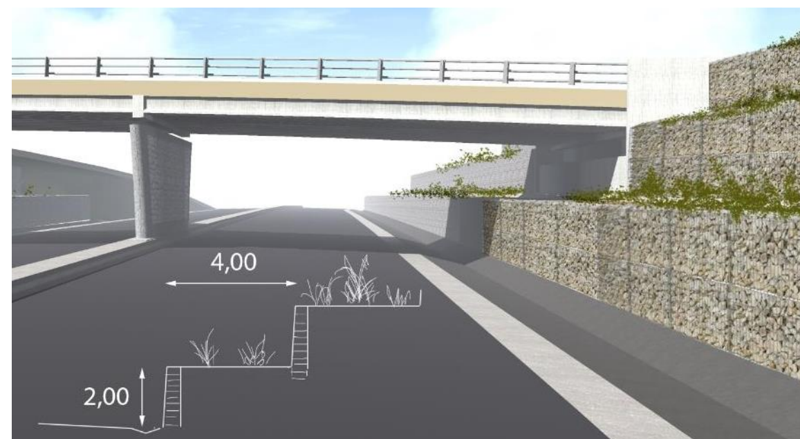
Figure 25 : trémie ouverte avec murs en restanques
