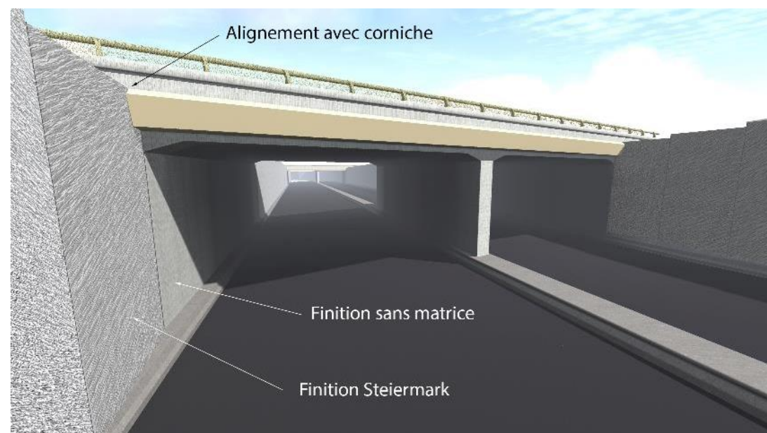
Figure 26 : trémie ouverte avec murs de soutènement
